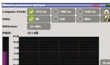
Mesure de puissance optique sur l'entrée fibre optique
