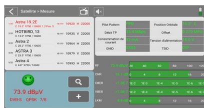
Menu de mesure (puissance et qualité) du signal Satellite
